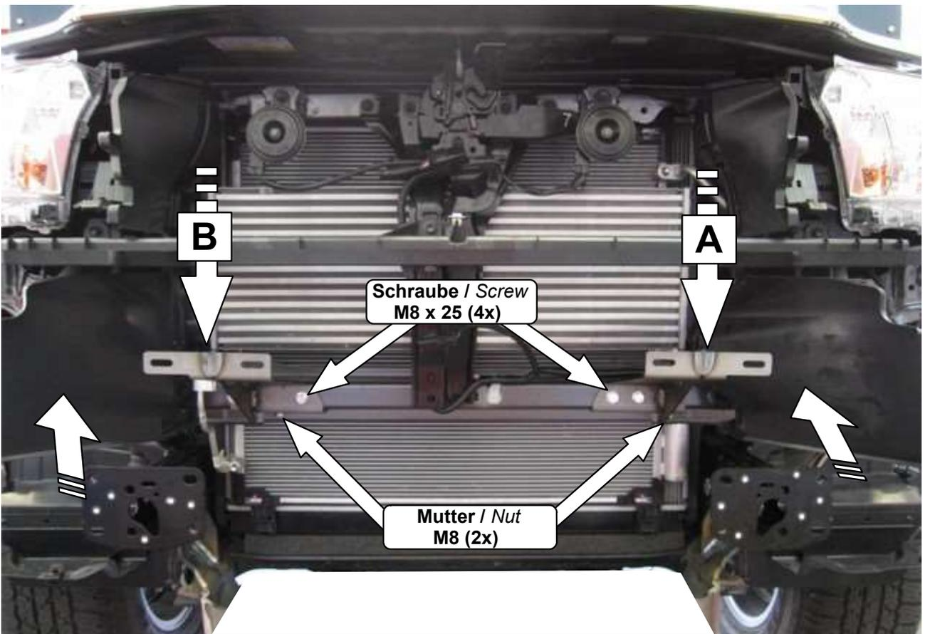
**5** Halter montieren und luftleitformteile wieder einsetzen!
